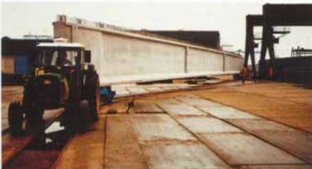
Bild 9 a. Transport des sehr schlanken Trägers zum Lagerplatz Fig. 9 a. Transport to the stockyard of the very slender beam Fig. 9 a. Transport au lieu d'entreposage d'une poutre profilée
