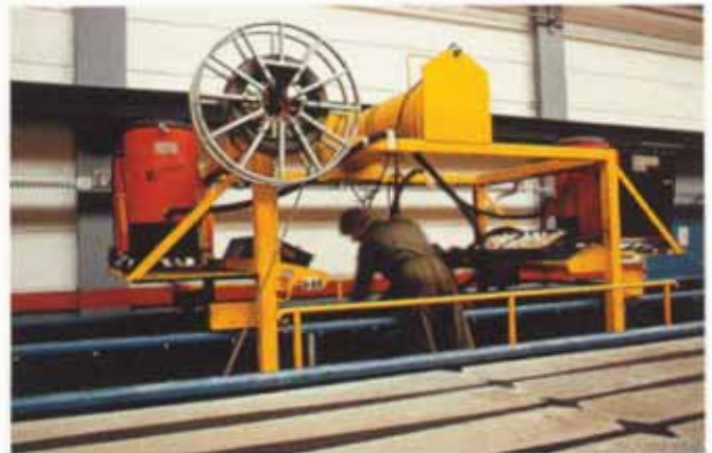
Bild 15 a. Der Spezialwagen fährt an der Anlage entlang, um die Arbeiter zu entlasten Fig. 15 a. Specially-designed wagon moving along the line to ease the work for the employees Fig. 15 a. Chariot spécial se déplaçant le long de la ligne pour faciliter le travail du personnel
