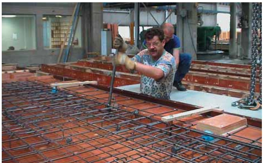
Foto 1.014: Productie van een wand met veel stekankers en zwaar gewapend. Lagere investeringen, hoge maninzet.
