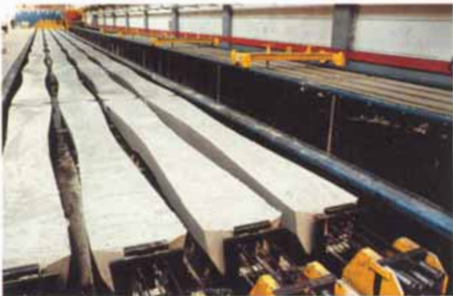
Bild 16. Nach dem Ausformen sind die Schwellen noch miteinander verbunden Fig. 16. The still-connected sleepers after demoulding Fig. 16. Traverses toujours réunies, après leur démoulage
