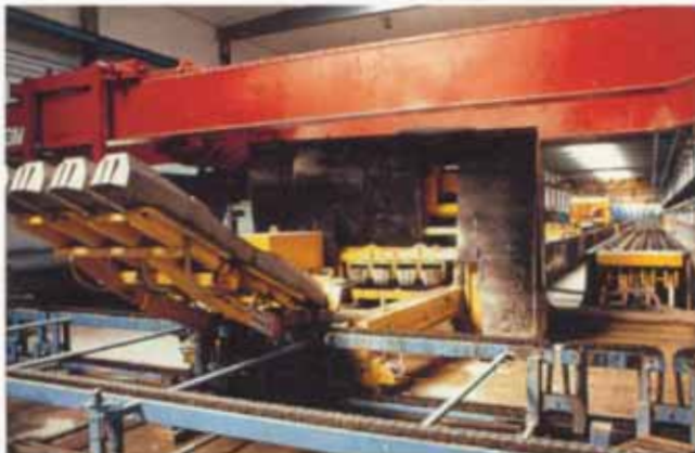
Bild 17. Sobald die Verbindungen durchgesägt sind, werden die Schwellen um 180 Grad gedreht Fig. 17. After the sleepers are separated by sawing they are turned through 180 degrees Fig. 17. Après avoir été séparées par sciage, les traverses sont tournées de 180 degré
