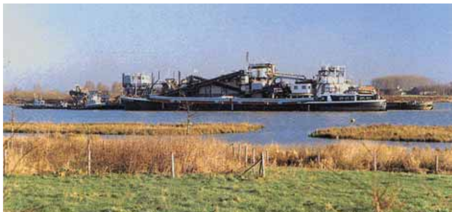
Foto 1.020: Grind- of zandbaggerinstallaties
