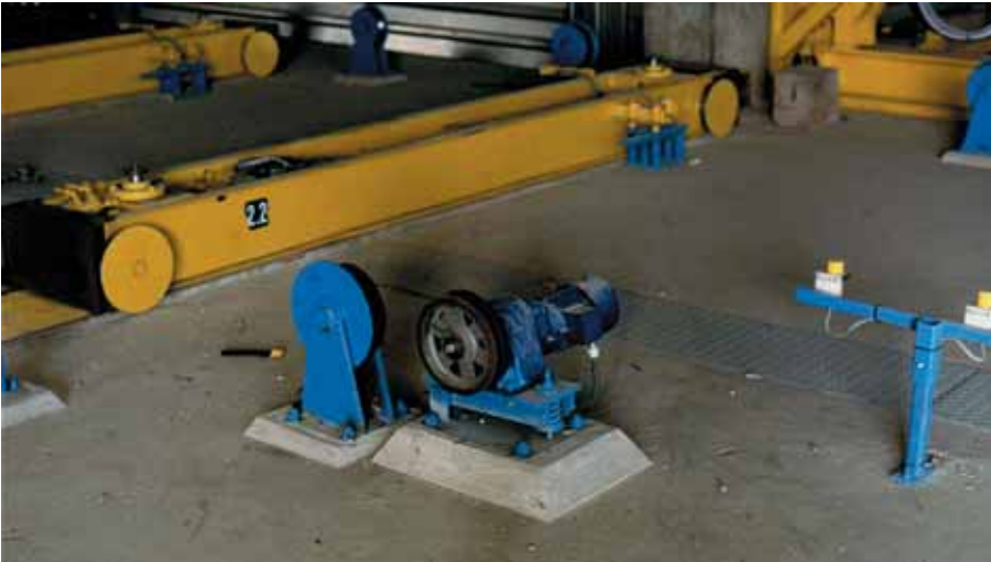
Foto 2.039: Geleidesysteem met rollen voor de tafels, ook wel platforms genoemd. Op een aantal rollen is een motor bevestigd voor de voortstuwing van de tafel
