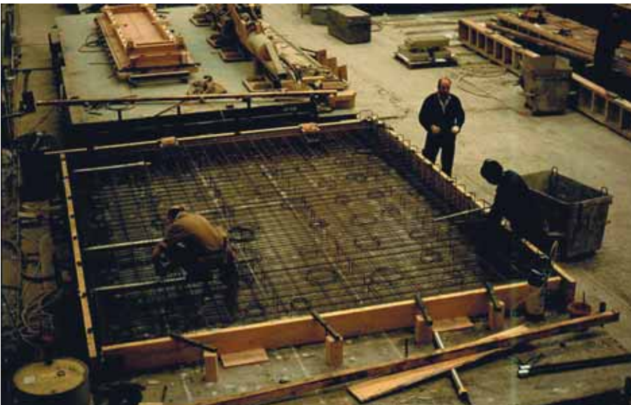
Foto 2.041: Tafel van een omloopsysteem. Op de tafel wordt ingebouwd
