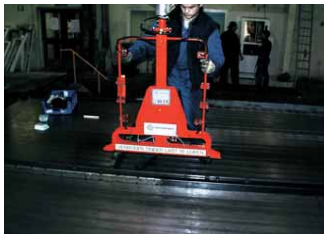
3 | Seriegrootte 1: plaatsen van een magneetlijst met de manipulator
