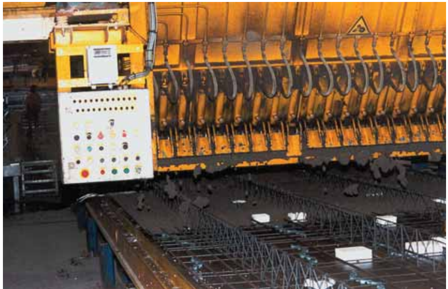
Foto 2.048: Moderne stortmachine met te openen en te sluiten kleppen, waardoor de dosering van de betonspecie voor vlakke elementen nauwkeurig kan plaatsvinden. Ter plaatse van sparingen of schuine zijden wordt geen beton gestort; een of meer kleppen sluiten dan tijdelijk. Deze stortmachine is CAD-CAM-gestuurd
