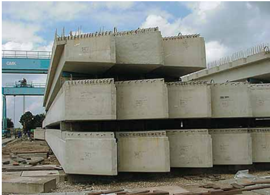
Foto 2.060: Kokerbalken op het tasterrein opgeslagen in 3 lagen. De balken liggen met overstek om het moment tengevolge van het eigen gewicht in het midden van de balklengte te minimaliseren en zo de zeeontwikkeling niet te veel te beïnvloeden. De ligger wil in de tijd verder naar boven opbuigen
