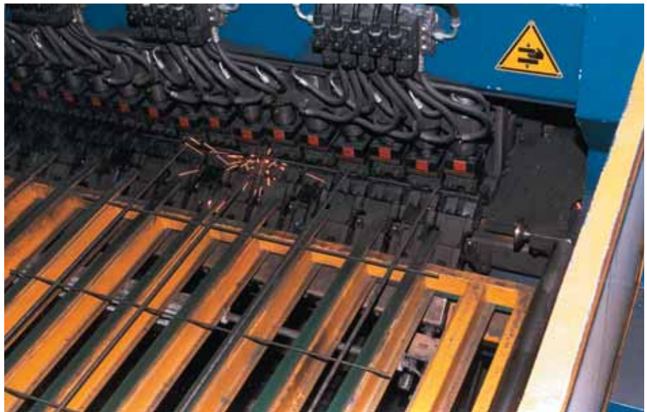
Foto 2.028: Automatisch lassen van alle kruisingen van staven voor een wapeningsmat. Deze productie is CAD-CAM-gestuurd
