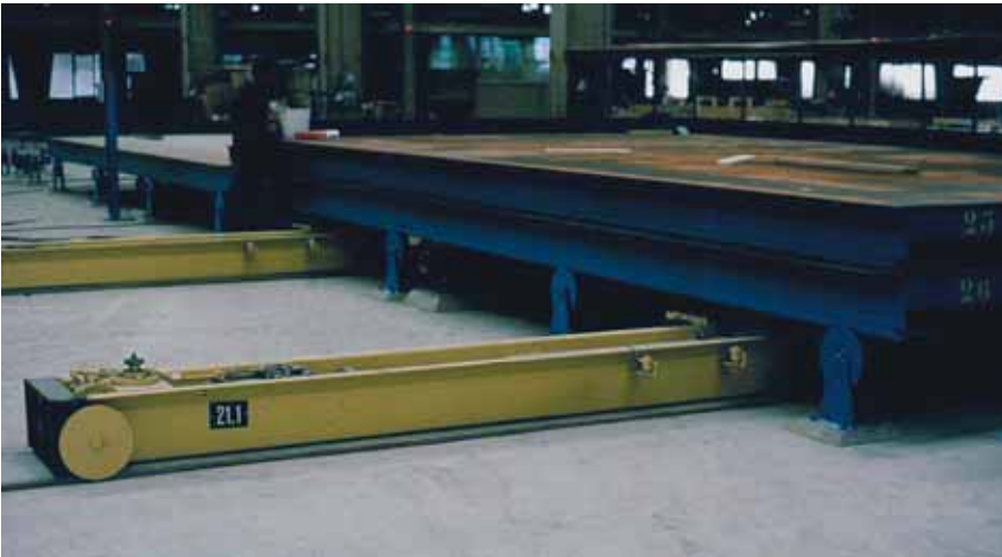
Foto 2.040: De tafel kan ook uit de omlooproute worden weggehaald. De 'kamelen' of 'hondjes' zijn voorzien van vijzels, die de tafel van de rollen tillen. De tafel gaat dan dwarsuit naar een nieuwe positie buiten de route en kan later weer in de omloop worden ingevoegd
