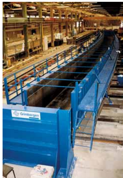
4 | Bekisting voor horizontaal gebogen, voorgespannen liggers
