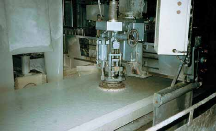
Foto 2.051: Een beeld van de geleiding van de polijstmachine zelf
