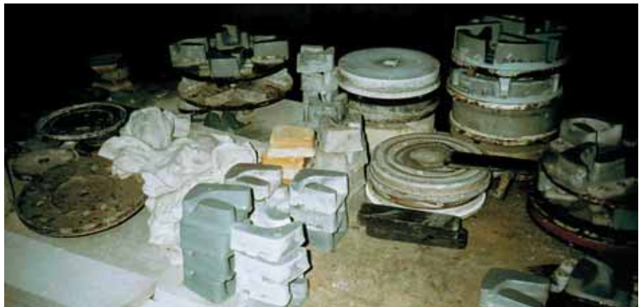
Foto 2.049: Het polijsten van beton is een aloude bezigheid die nu modern wordt uitgevoerd met polijstmachines. Het slijpen, afschrappen van de lagen, van het betonoppervlak gebeurt in verschillende stappen, van grof naar fijn. De schuur schoen is uitgevoerd met een carborundem of industriediamant. Een aantal schoenen is hier zichtbaar
