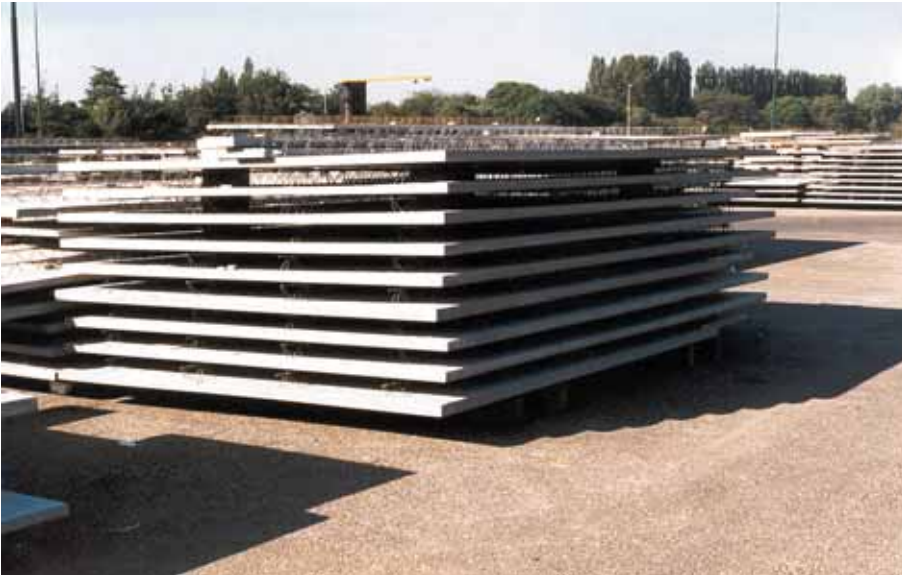
Foto 2.008: Stapel geproduceerde bekistingplaat; deze worden zo kort mogelijk in opslag gehouden, omdat de rekening pas uit kan als er is geleverd
