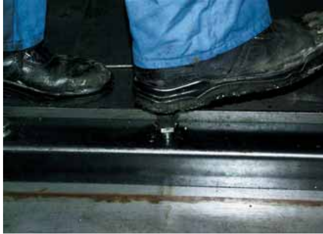
4 | Vastzetten magneetlijst met een magneet-veerconstructie
