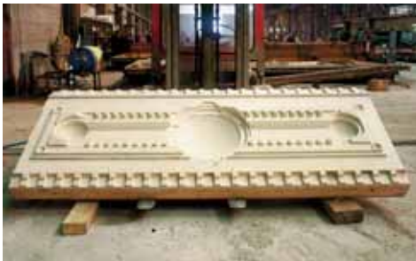
12 | Bekistingsdetail in polyurethaan voor het gebouw van foto 11
