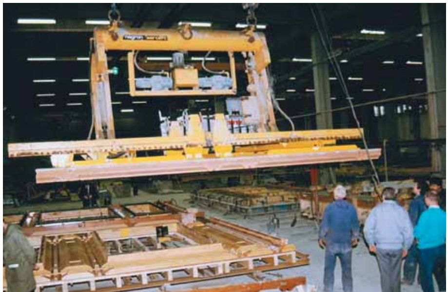
Foto 2.054: Het element is gereed voor rotatie. In de wandeling noemt men dit een vacuüm-kantelzuiger
