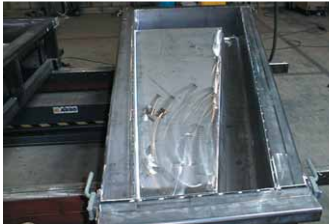
Foto 2.020b: Mal in bewerking; let op de hechtlassen vanwege de vormvastheid tijdens het vervaardigen van de stalen mal
