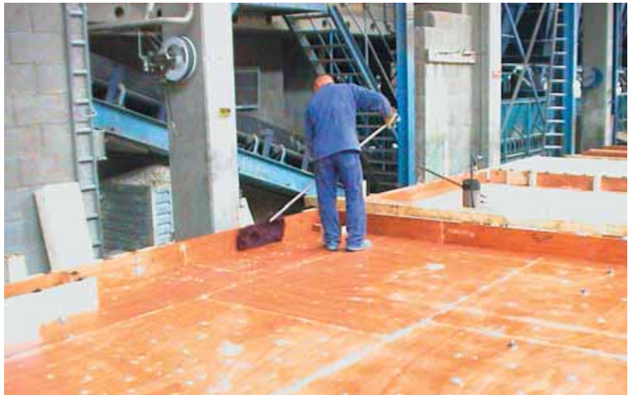
Foto 2.042: De mal wordt zorgvuldig gereinigd. Zie ook het geplamuurde en gladde gelakte oppervlak
