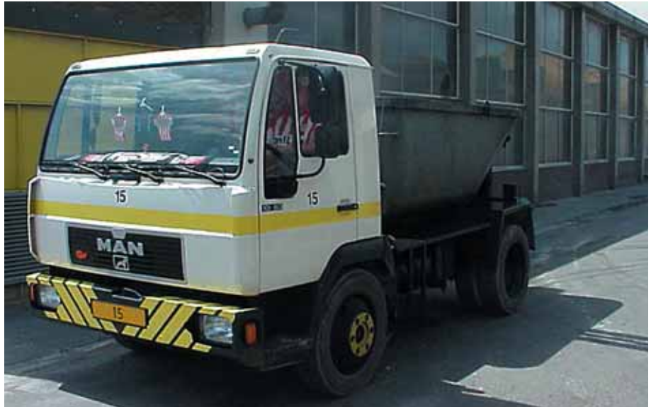
Foto 2.037: Betontransport vanonder de betonmenginstallatie tot aan een betontransport in een hal. Het te transporteren volume is afgestemd op de charge van de menger
