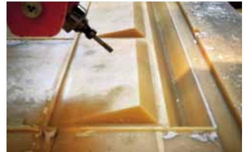
14 | Experimenten in was: freesrobot aan het werk op cannelure
