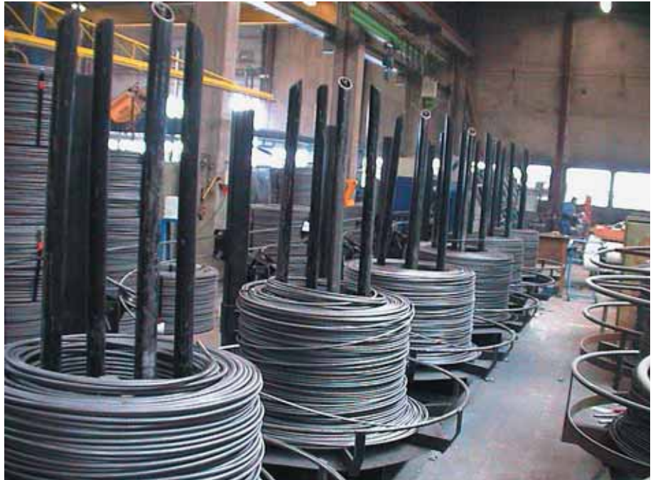
Foto 2.027: Wapeningcoils voor de voeding van de knip-, strek- en buigmachine
