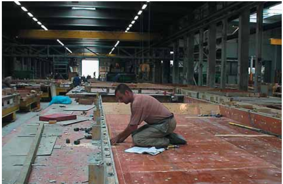
Foto 2.043: De start van het aangeven van de voorzieningen op de malranden
