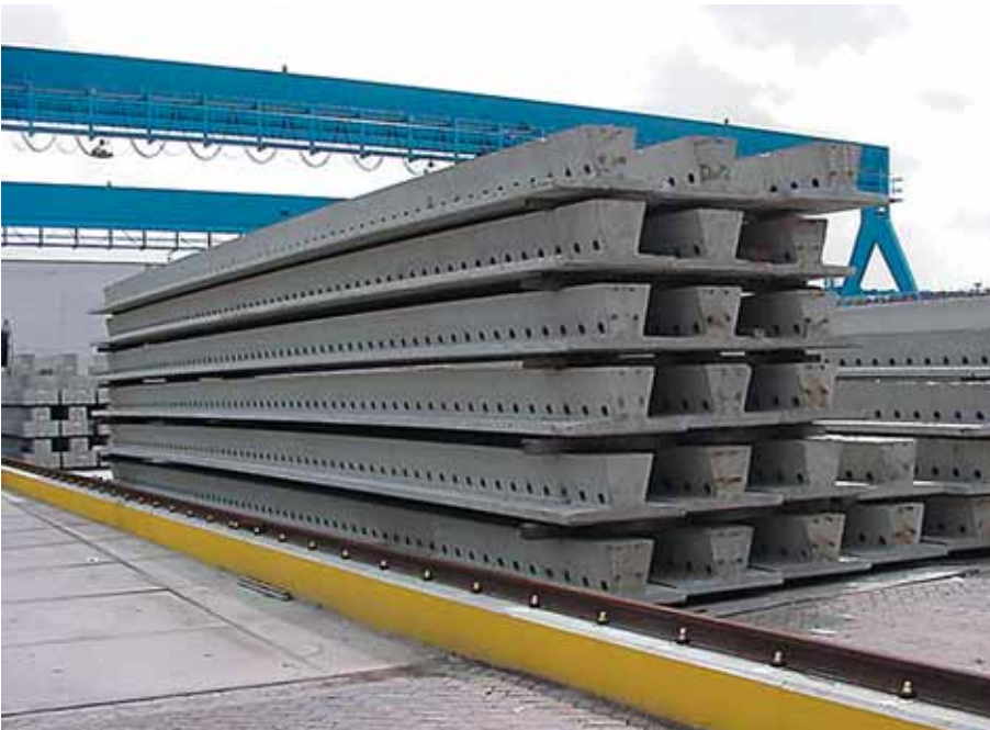
Foto 2.063: De stapeling van de liggers 6 lagen hoog, maar wel met een gelijk overstek
