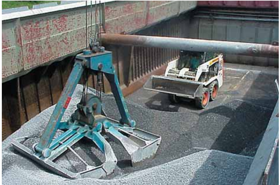
Foto 2.031: Met de shovel wordt het grind bij elkaar gebracht. Met de knipper wordt het grind gelost
