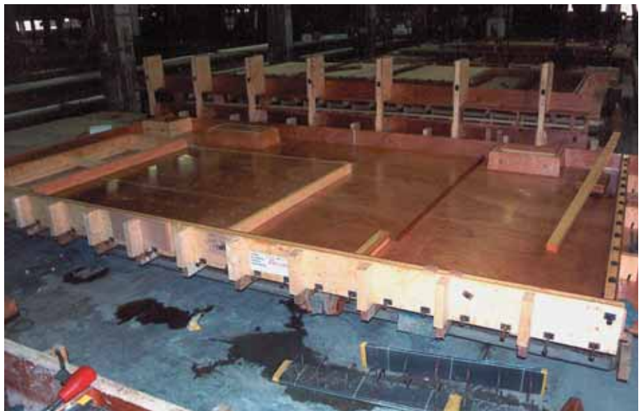
Foto 2.007: Malaanpassing om verschillende elementen – merken – in een basismal te kunnen maken en elk element binnen een cyclus van 24 uur te kunnen vervaardigen
