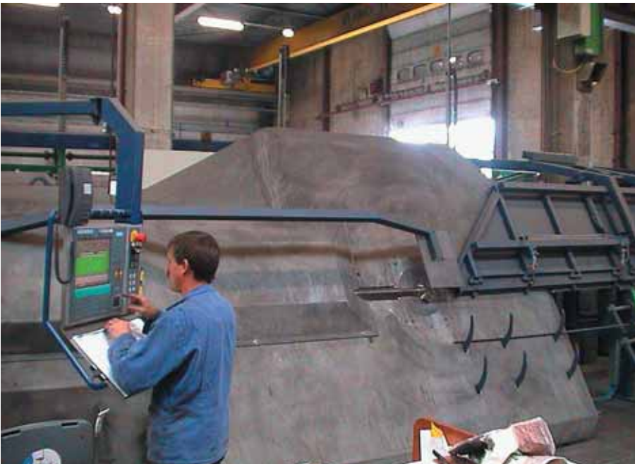
Foto 2.026: Knip-, strek- en buigmachine. De wapening van de coil wordt verwerkt tot staven, beugels of haarspelden. Diameter, ontwikkelde lengte, vorm en aantal kunnen worden geprogrammeerd
