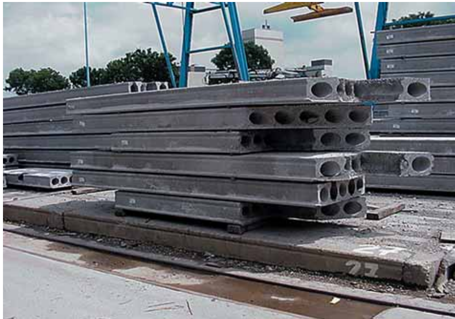
Foto 2.003a: Voorraad van gestapelde – korte – kanaalplaten met springen en schuine kopzijden. De platen liggen op overstek, met de stapelpunten recht boven elkaar!
