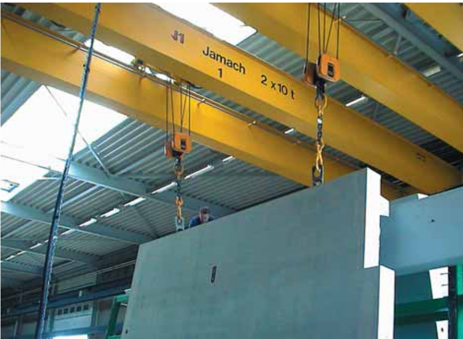
Foto 2.059: De halkraan brengt het element naar een tijdelijke verblijfspositie binnen, om zonodig te worden nabewerkt ingeval van onvolkomenheden
