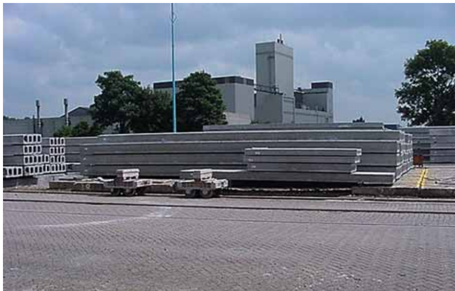
Foto 2.003b: Voorraad van gestapelde – lange, hogere – kanaalplaten. De platen worden gestapeld op overstek om de toename van de opwaartse kromming door kruip te verminderen!
