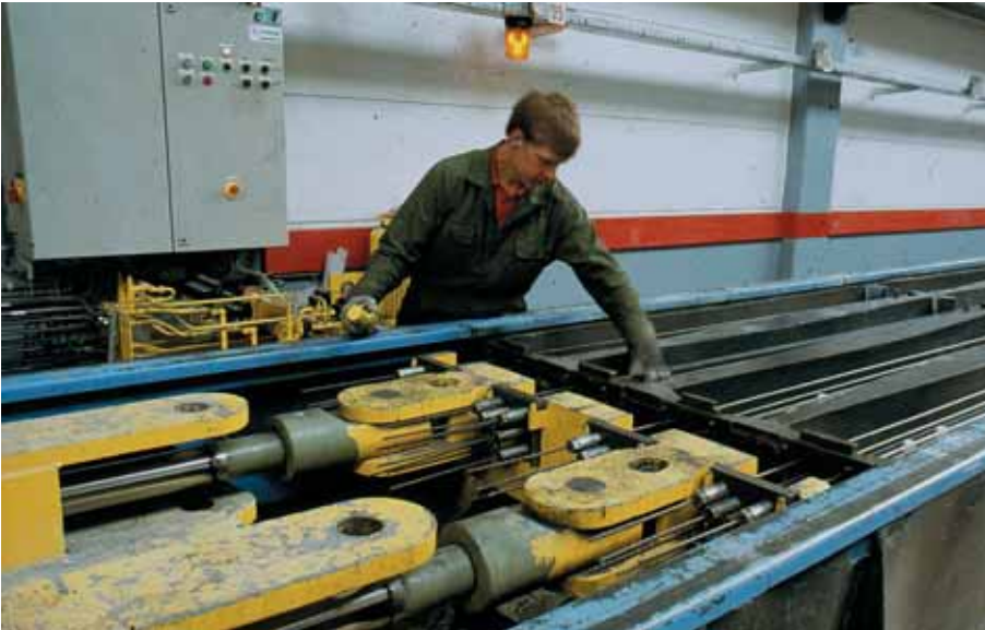
Foto 3.032: Door de vijzel wordt de eindplaat met verankerde strengen achterwaarts getrokken, totdat de gaten in de geelgeverfde platen corresponderen
