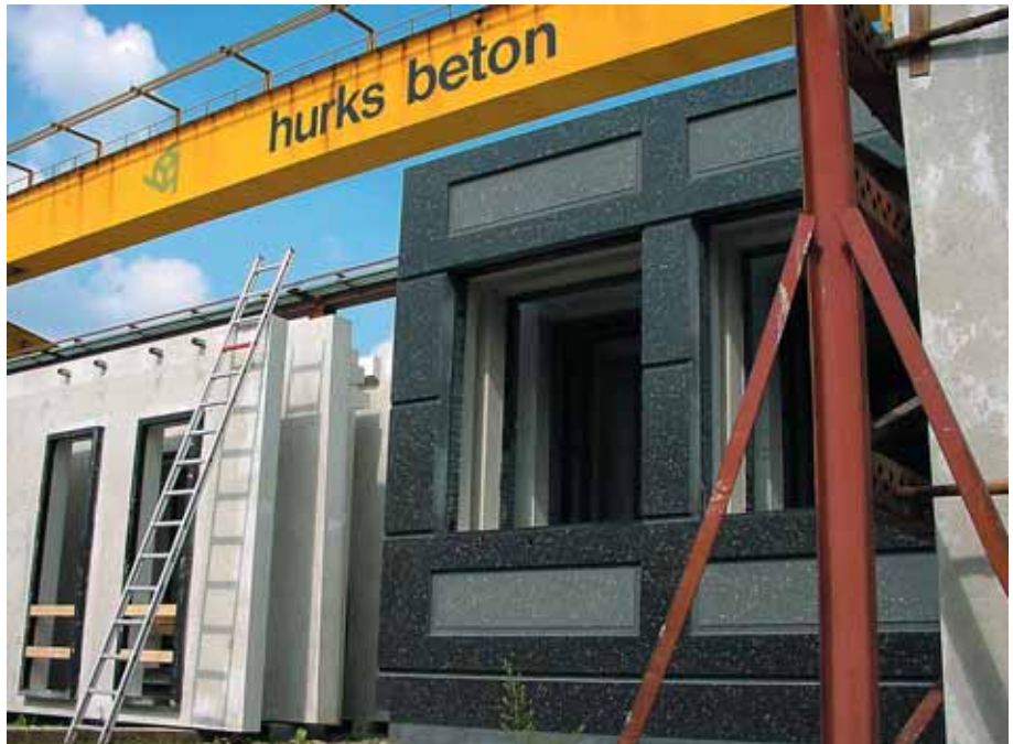
Foto 3.202: Het sandwichelement is gereed en staat op de tas gereed voor transport
