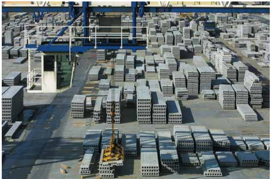
Foto 3.057: Overzicht van de vakken en stapels op het tasterrein. De portaalkraan overspant de gehele breedte van het opslagterrein. De platen worden in genummerde vakken gestapeld en zijn zodoende terugvindbaar
