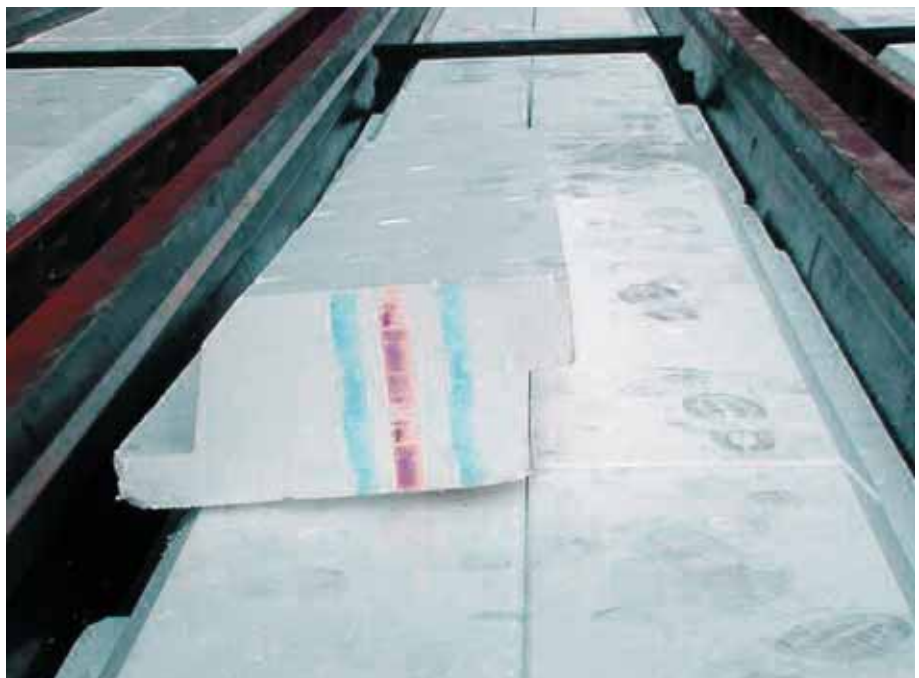
Foto 3.062: Een beeld van de doorsnede van de isolatieplaten, die tevens malvorm zijn
