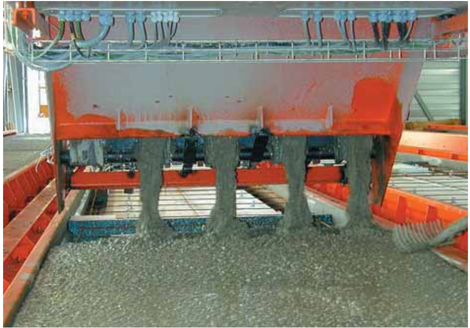
Foto 3.069: Stortkubel met vier kleppen open. Het kopschot is van hawkariet, gerecyclede kunststof
