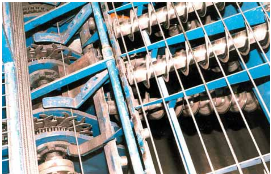
Foto 3.093: De langsstaaf wordt geknipt van de aangevoerde draad. In geval van een sparing wordt de staaf voor en na de sparing geknipt. Daarna rolt de staaf of rollen de twee staven omhoog
