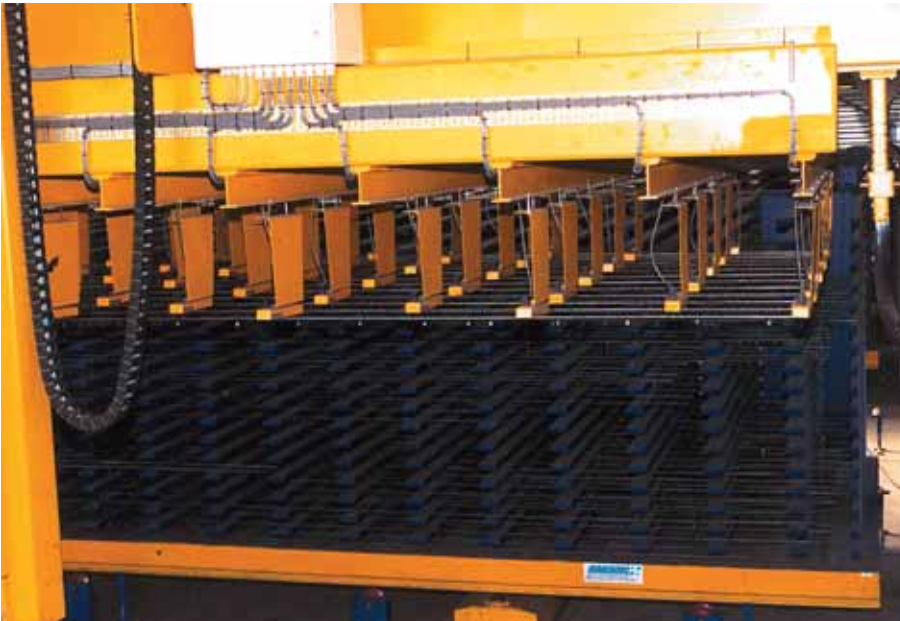
Foto 3.099: De mat wordt automatisch naar een positie in de buffer gebracht en daar ingeschoven. Plaats en matnummer zijn bekend, zodat het ook weer oproepbaar is. De buffer geeft de mogelijkheid om vooruit te produceren, zodat de toelevering van een wapeningnet nooit maatgevend zal worden. Er zal altijd een voorraad zijn voor 8 uur productie, zodat storingen binnen die tijdsduur verholpen kunnen worden zonder stagnatie te veroorzaken
