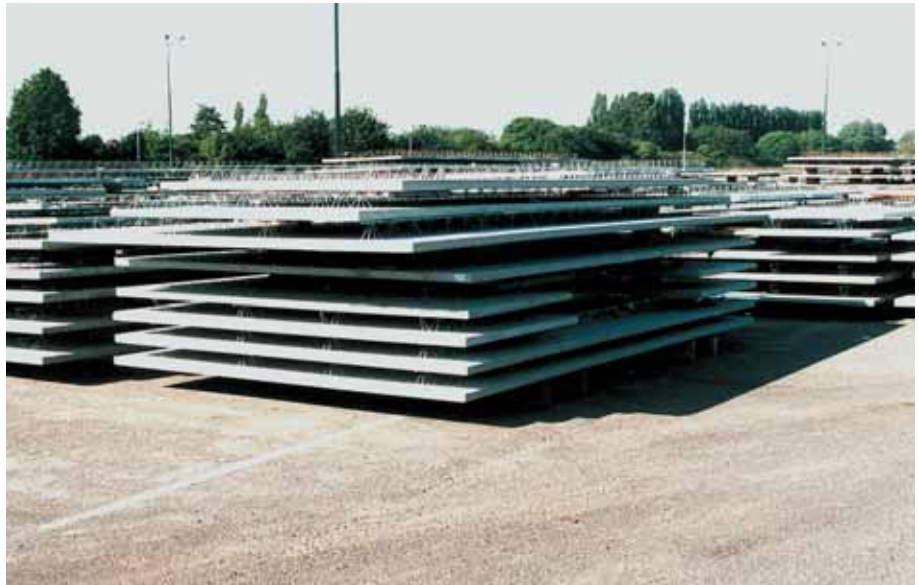
Foto 3.077: De stapel, het uitgangspunt van het logistieke proces. De elementen worden per vloer opgedeeld in vrachten en deze weer in stapels. Daarop worden de voorbereiding en de productie gestuurd
