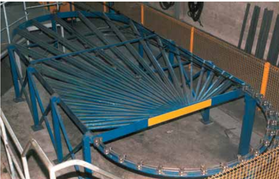
Foto 3.091: De wapening wordt gestrekt en rondgevoerd voor de dwarswapening van het te produceren net
