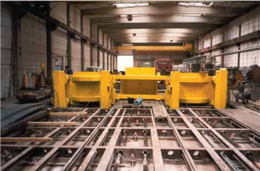
Foto 3.022: Spanunit van 20 000 kN voorspankracht voor brugbalken. De hal bevindt zich in de ombouwfase
