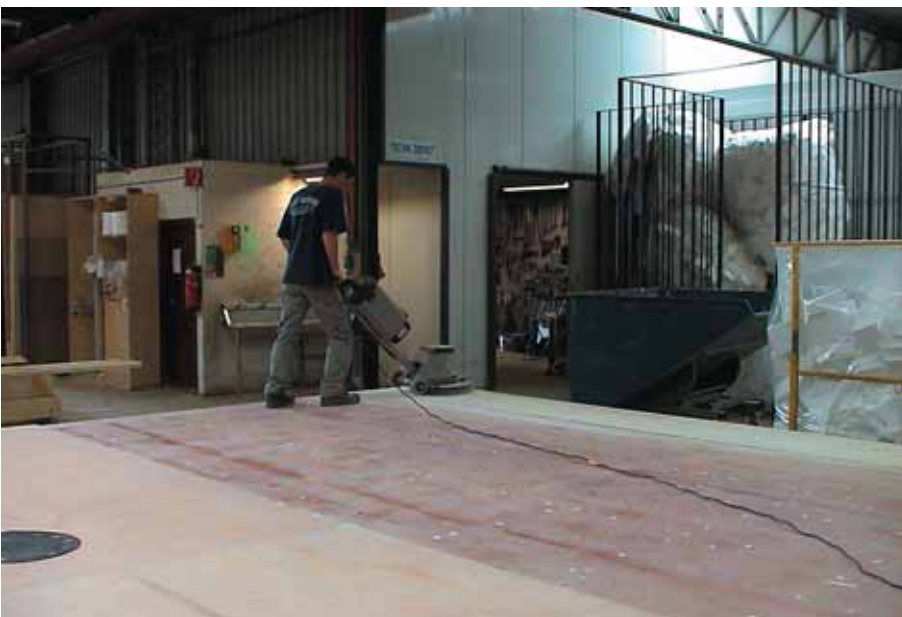
Foto 3.135: De houten mal is een basisuitgangspunt. De malzijden en -bodem dienen glad te zijn
