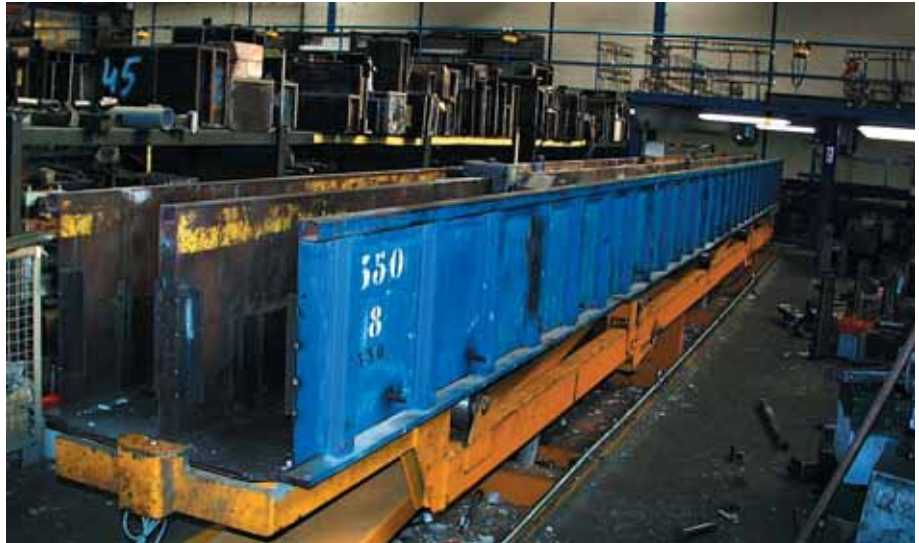
Foto 3.007: Mal voor dubbele productie. Het middenschot blijft staan. De 'oude' palenkisttechniek
