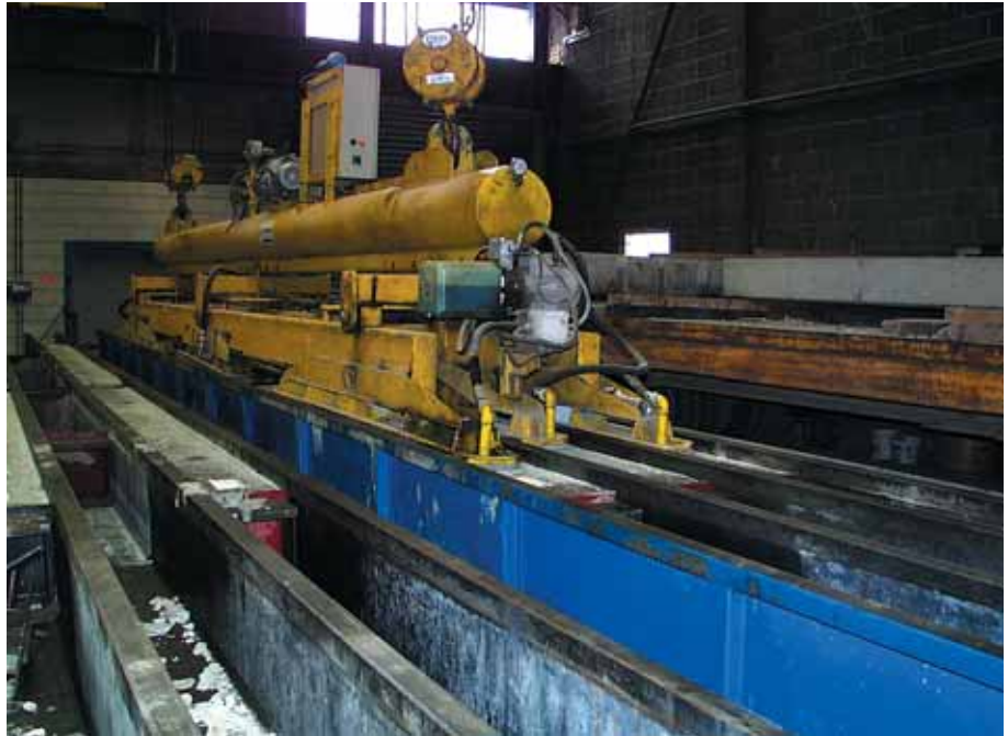
Foto 3.115: Zoals voorgaand; meerdere palen tegelijk uit de mal halen
