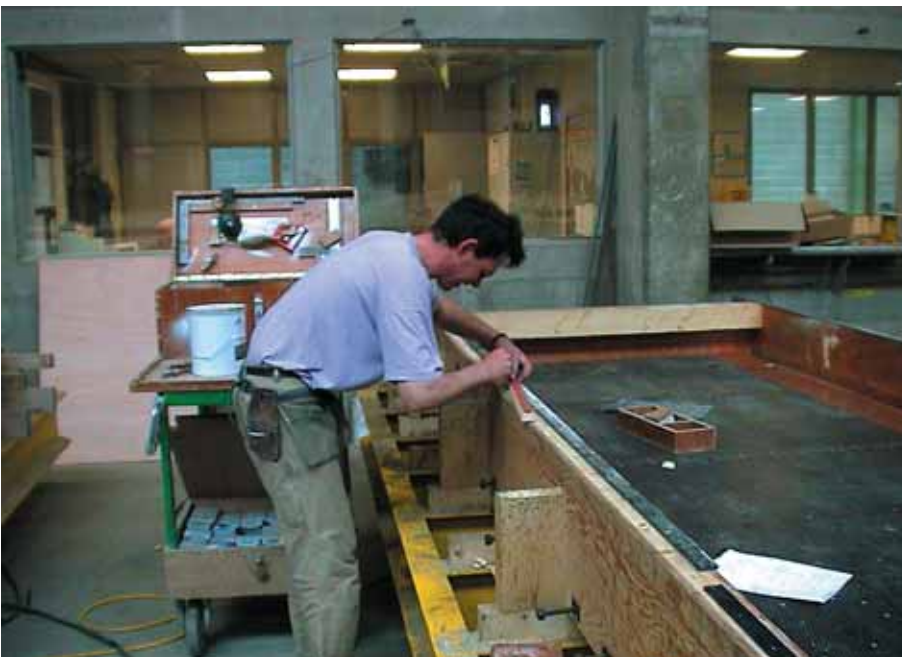
Foto 3.140: De mal wordt klaar gemaakt; maatvoering voor voorzieningen
