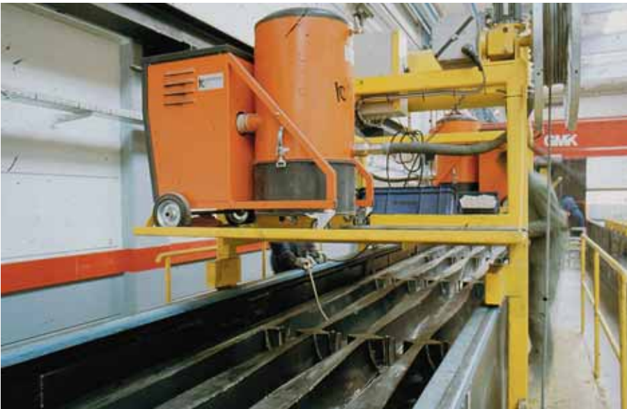
Foto 3.025: Voor het schoonmaken van de mal, die 1,60 m breed is en circa 90 m lang, wordt een kar op de baan gebracht, die langs de baan kan rijden. Staand op de kar kan men met twee man in een ergonomisch juiste houding de vereiste montagewerkzaamheden verrichten
