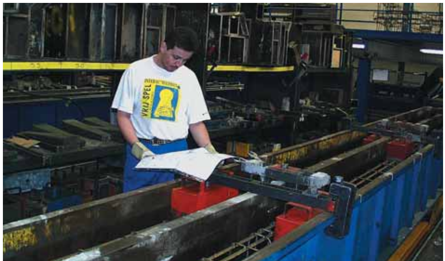
Foto 3.015: De inkassingen zijn opgehangen, waardoor later de oplegging van een aansluitende balk mogelijk wordt
