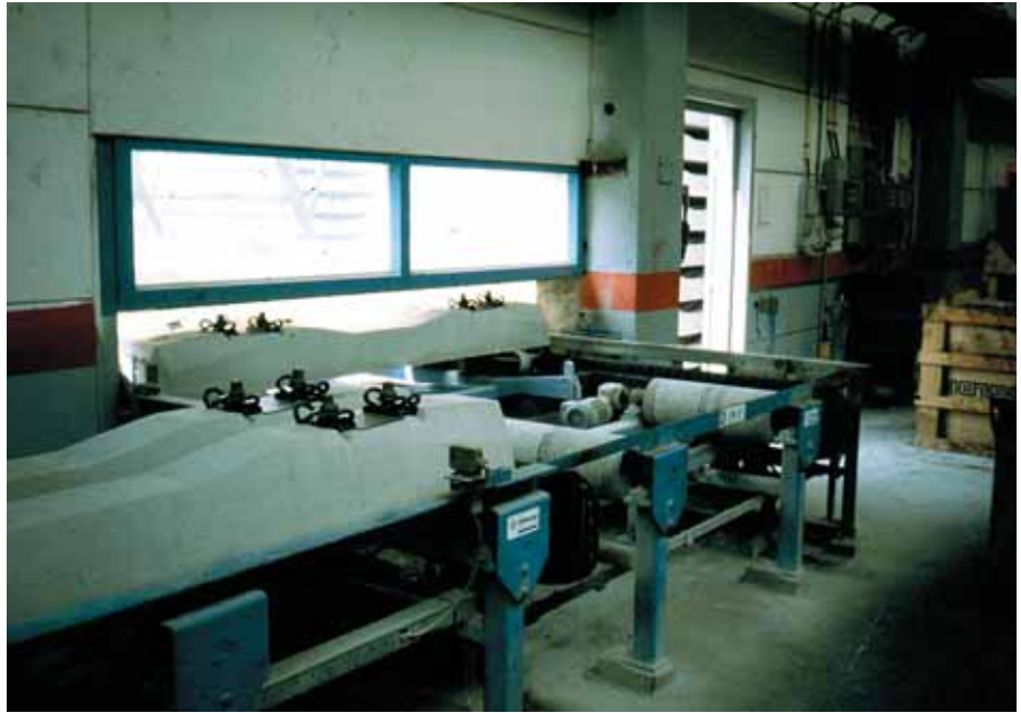
Foto 3.038: De gerede dwarsliggers worden vervolgens naar buiten gerold, waar ze per tien stuks verzameld worden
