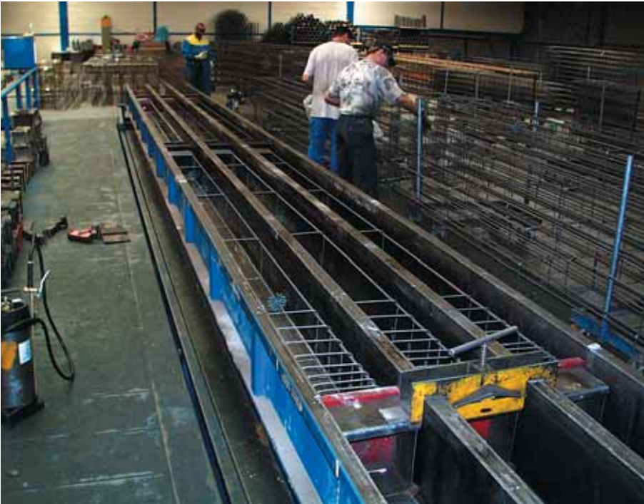
Foto 3.125: Mal is ingebouwd en gereed voor het storten
