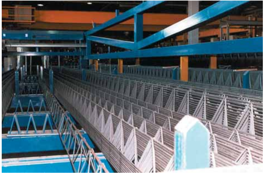
Foto 3.104: Sorteren per plaat. De functie van de tralieligger is: verstijving, hijsmogelijkheid geven, afstandhouder bovenwapening en afschuifwapening in het contactvlak plaat en in situ beton
