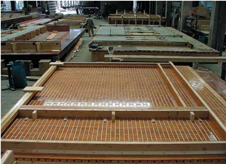
Foto 3.204: Mal voor het inleggen van stenen, die worden ingestort als afwerking
