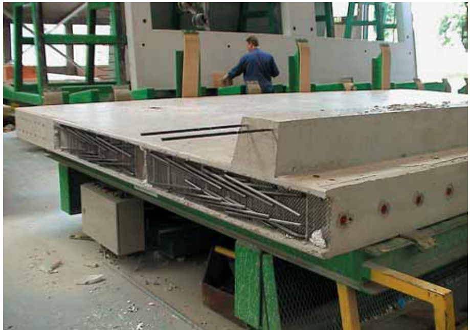
Foto 3.162: Een stekkenbak is in dit element opgenomen. Wapening later om te zetten om een natte verbinding te kunnen maken
