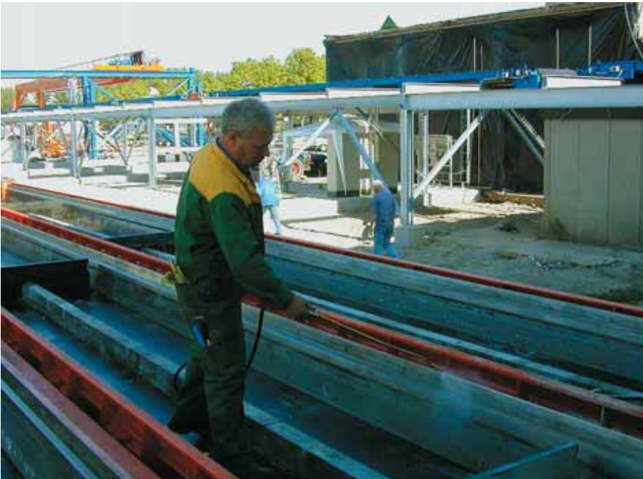
Foto 3.060: De mal wordt in de olie gezet
