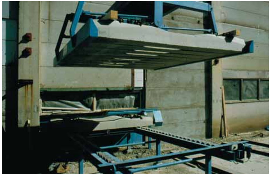
Foto 3.039: Er wordt een lat aan beide zijden gelegd. De automatisch werkende kraan pakt de tien dwarsliggers tegelijk op en positioneert ze op een - volgens het geheugen - vrije positie
