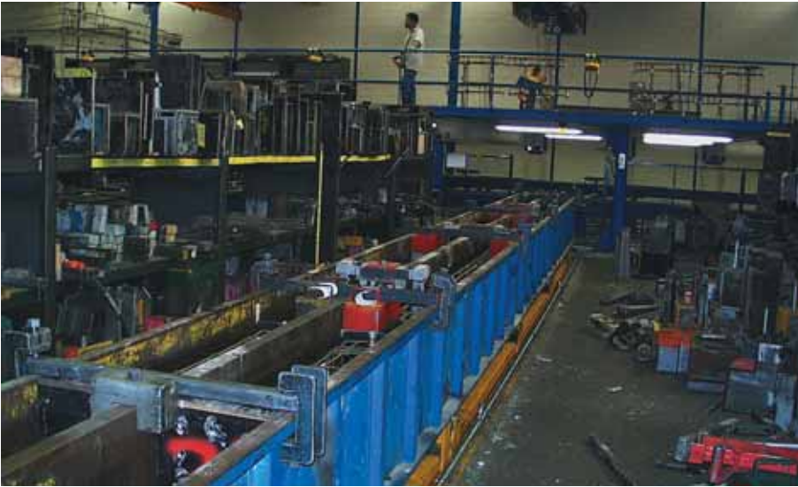
Foto 3.016: Balken zijn bijna stortgereed. De mal kan over een rollenbaan worden getransporteerd naar de stortpositie
