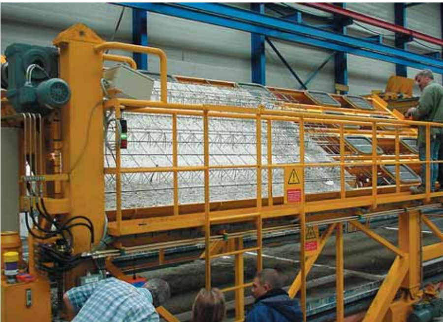
Foto 3.180: A-schil kantelen, met behulp van vacuümapparatuur
