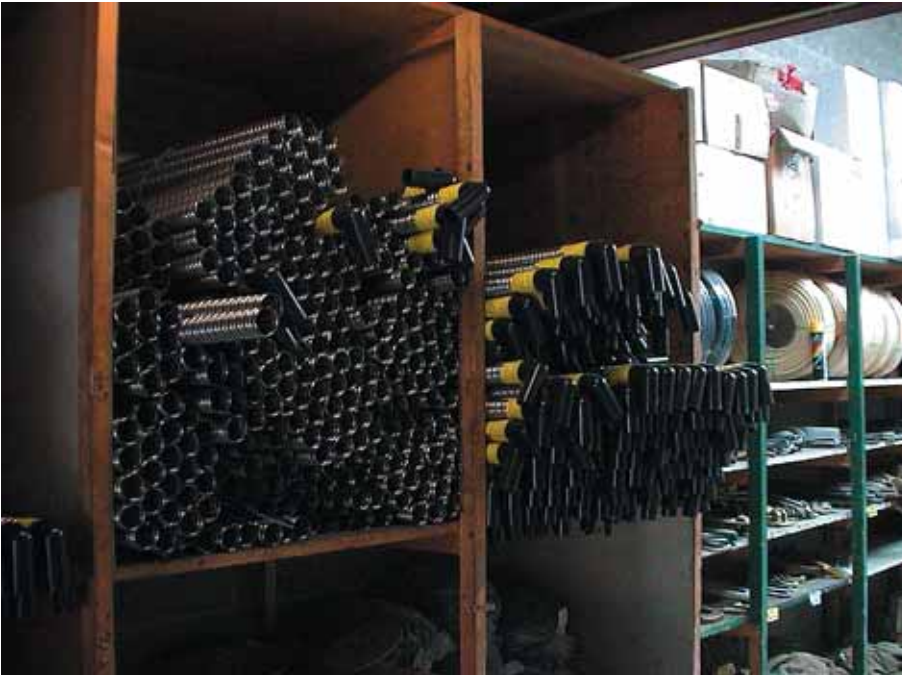
Foto 3.139: Omhullingsbuizen compleet en andere in te storten voorzieningen op voorraad
