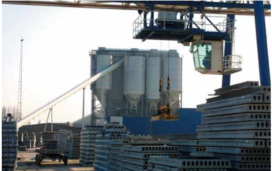
Foto 3.052: De silo's en opvoerband van de betoncentrale steken ver boven alles uit. De portaalkraan wordt bediend vanaf maaiveld of vanuit de cabine, waar de kraanmachinist een goed overzicht heeft over het tasveld. De zijlader is op weg platen aan te voeren, die verder worden uitgesorteerd
