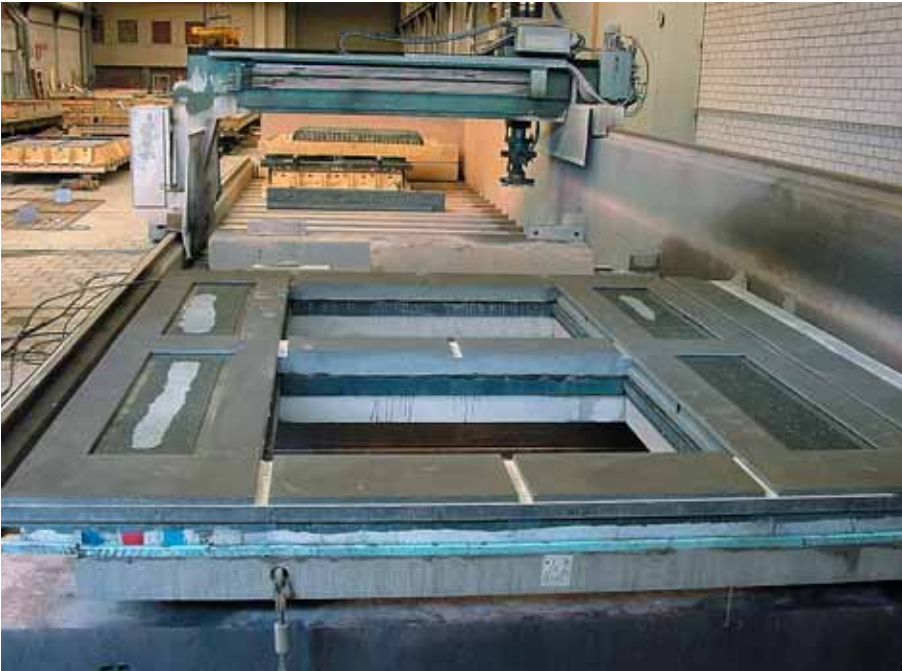
Foto 3.199: Het element is ontkist en met het buitenvlak naar boven neergelegd bij de polijstraat. De opbouw is duidelijk zichtbaar
