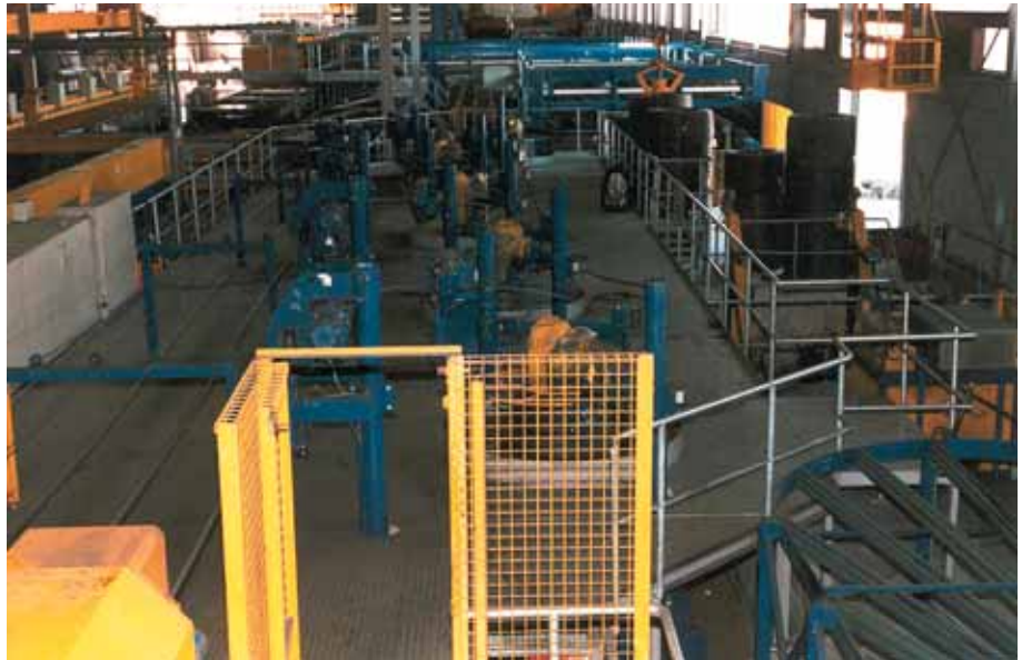
Foto 3.089: De wapening wordt volledig automatisch, CAD-CAM geproduceerd. De coils worden automatisch geplaatst door een robotarm
