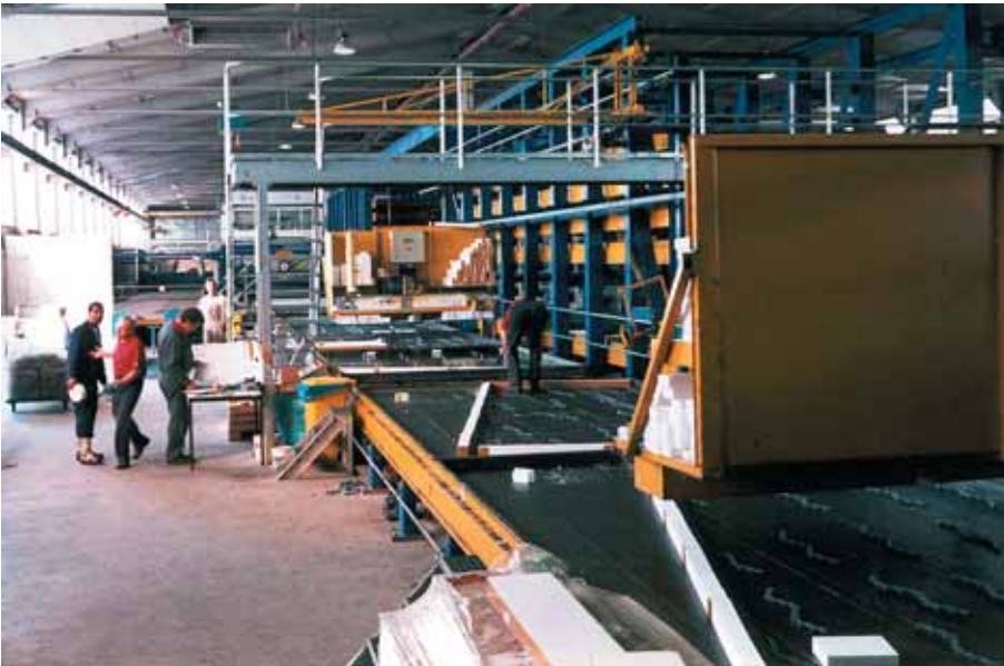
Foto 3.087: De dekkingsringen worden aangebracht, de sparingen van PS geplaatst. Schuine beëindigingen worden eveneens gemaakt van PS. De robotarm plaatst alleen de haakse kopschotten op de tafel. De te gebruiken materialen bevinden zich op de materiaalwaggen
