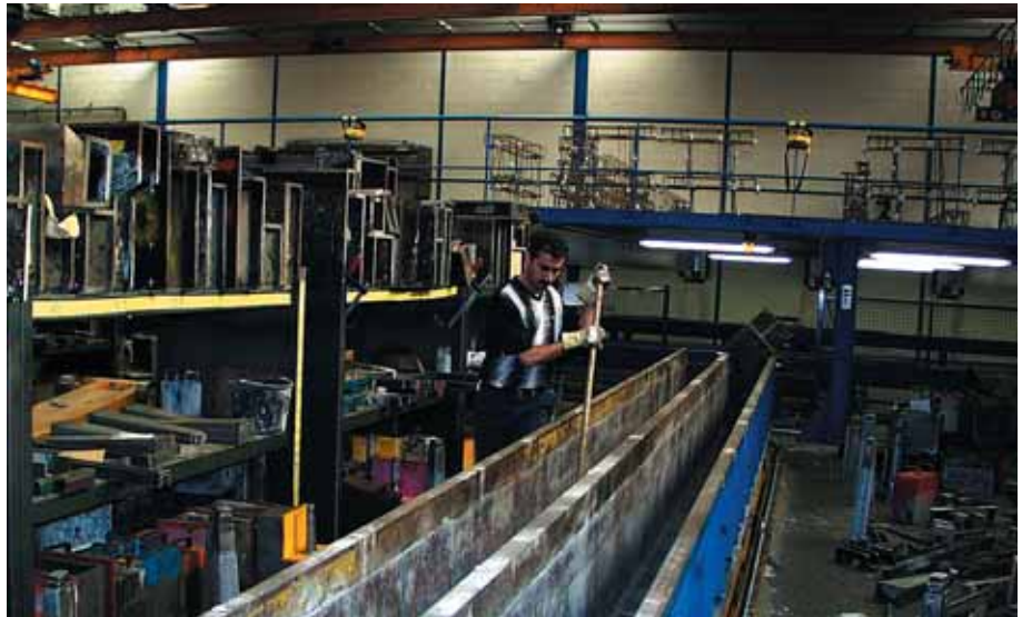
Foto 3.008: Reinigen van de mal, daarna oliën. Zie de grote voorraad opgeslagen kopschotten en voorzieningen
