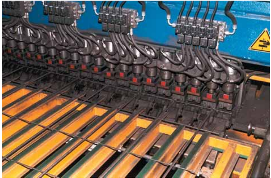
Foto 3.096: De mat wordt nu onder de laskoppen geplaatst. Daar waar een kruising van staven is, wordt een weerstandlas uitgevoerd om de hechting van de staven tot stand te brengen
