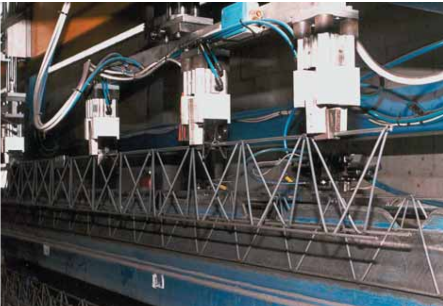
Foto 3.103: De tralieliggers worden toegeleverd en in het bedrijf zelf verlengd door ze te lassen en te knippen op de vereiste lengte. De op lengte geknipte liggers worden per plaat verzameld
