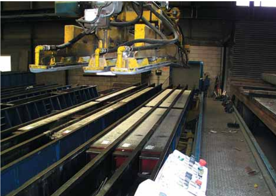
Foto 3.114: Palen ruimen met behulp van een vacuümapparaat. De mallen worden van onder iets opgedrukt, waardoor ze iets open gaan staan
