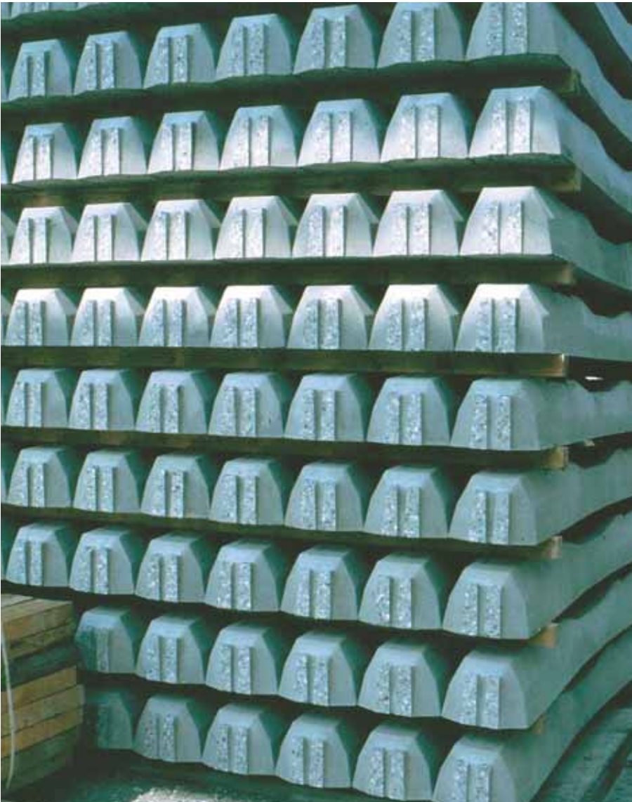
Foto 3.041: De dwarsliggers worden voorlopig maximaal tien hoog gestapeld. De kop van de dwarsligger laat twee smalle stroken beton zien, die twee opeenvolgende dwarsliggers in de baan verbinden. Deze worden doorgezaagd aan het eind van de baan
