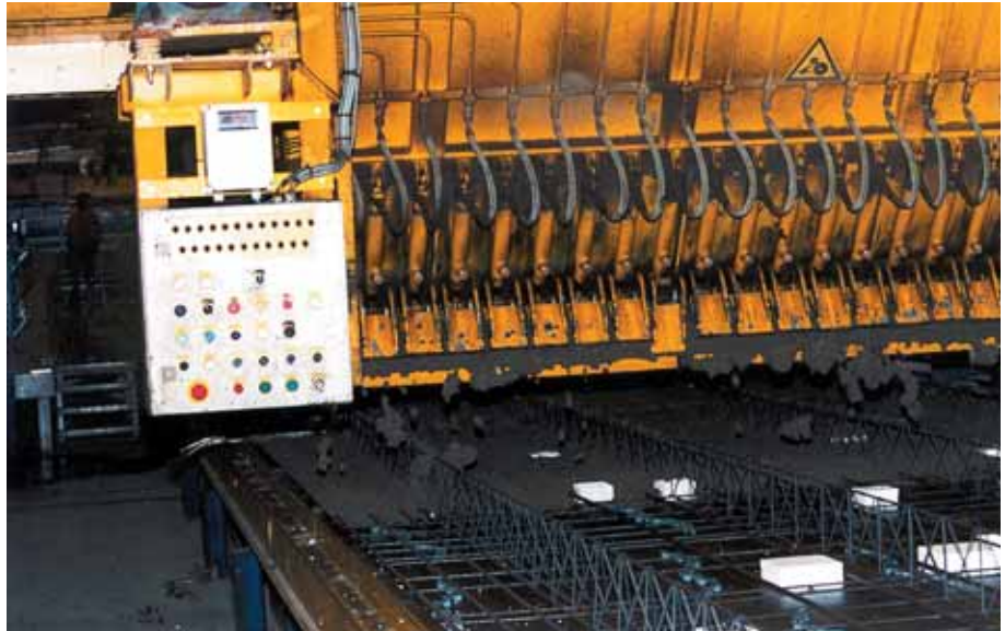
Foto 3.108: De veelkleppige stortmachine waarmee de hoeveelheid betonspecie uiterst nauwkeurig in een strook van 125 mm kan worden gedoseerd. De kleppen worden via CAD-CAM aangestuurd. De klep sluit bij een spring of afschuiving en aan het begin en het eind van de plaat
