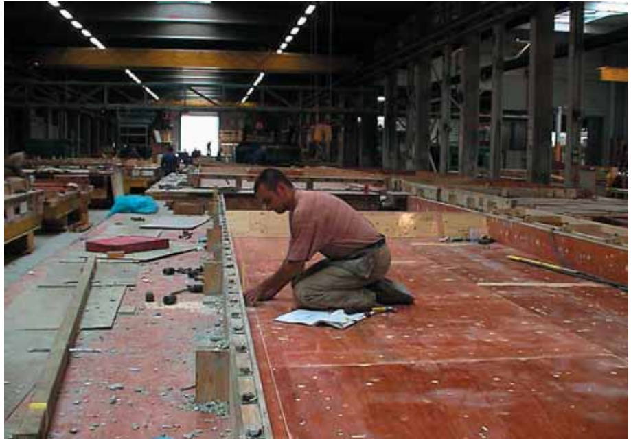
Foto 3.141: De modelmaker bouwt de mal op
