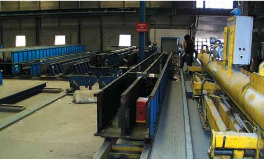
Foto 3.004: Verschillende mallen voor de diverse balkdoorsneden
