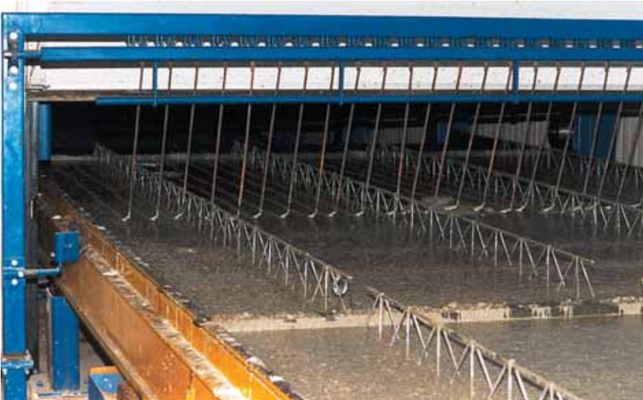
Foto 3.111: De gestorte tafel wordt in de klimaatruimte gereden. Daar is het 35-45°C en er heerst een hoge relatieve vochtigheid (R.V.)
