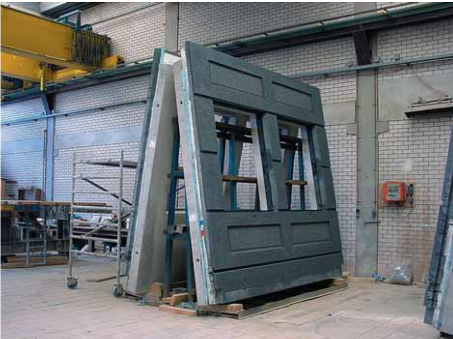
Foto 3.200: Twee gevelelementen staan tegen het frame. Het buitenoppervlak is gepolijst. De opbouw van het sandwichelement is goed zichtbaar
