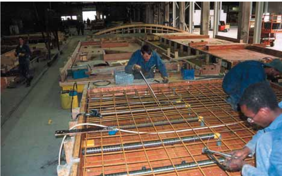
Foto 3.152: Een normaal wapeningnet, de voorzieningen worden dan ter plaatse ingebouwd
