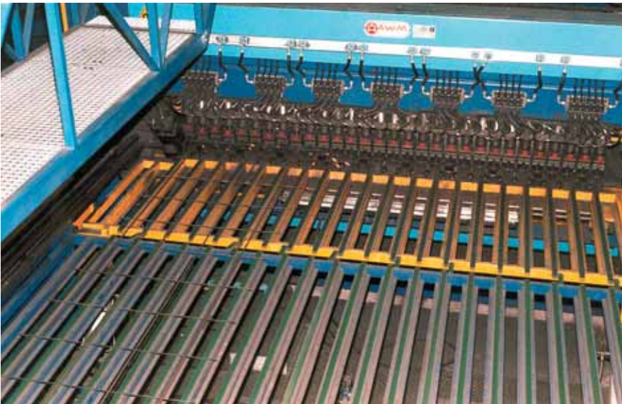
Foto 3.095: Als alle langsstaven aanwezig zijn, schuift de tafel op en wordt de eerste dwarsstaaf ingevoerd. Het rooster waarin de staven worden gelegd, meet 25 mm in beide richtingen. Dit correspondeert met de positie van de laskoppen
