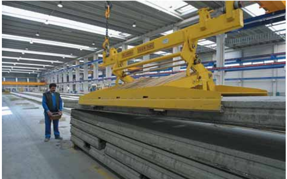
Foto 3.056: Platen vanaf de baan op stapel leggen met gebruik van de klem, die in de groef aan de zijkant van de plaat aangrijpt. De klem hangt aan een evenaar waardoor zowel lange als korte platen kunnen worden gehesen
