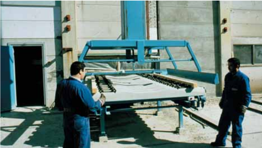
Foto 3.040: De volgende tien stuks zijn weer verzameld. De latten worden erop gelegd
