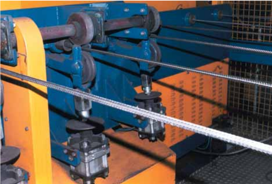
Foto 3.090: De wapening wordt vanaf de coils in de juiste diameter gestrekt en aangevoerd
