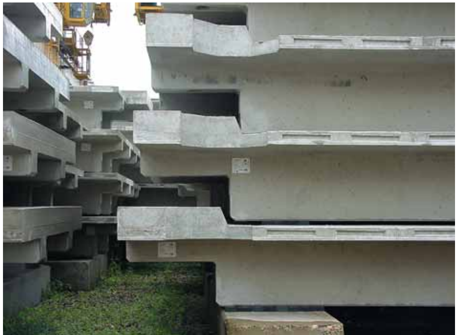
Foto 5.021: Duidelijk zijn de inkassingen te zien, die in de plaatrand van 80 mm zijn aangebracht. Deze zorgen dat na het verharden van de voegmortel dwarskrachten zowel loodrecht op de vloer als in het vlak van de vloer kunnen worden opgenomen. De rib is voorzien van een tand met een rechte beëindiging. De opstorting aan het eind is reeds in de fabriek aangebracht
