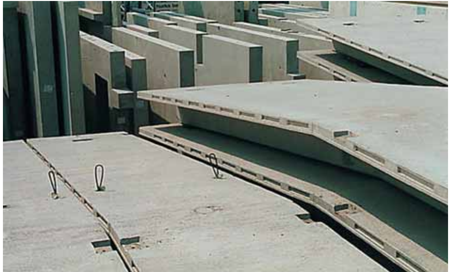
Foto 5.025: De hellingplaten worden gemaakt met zowel een opgaand als neergaand deel. De platen zijn voorgespannen met voorgerekt staal. Dat is mogelijk door de strengen in positie te houden vanaf het spannen tot en met het verharden van het beton. Doordat de strengen evenwijdig lopen aan de zwaartelijn van het element, gedraagt het element zich als elk recht element van dezelfde afmetingen
