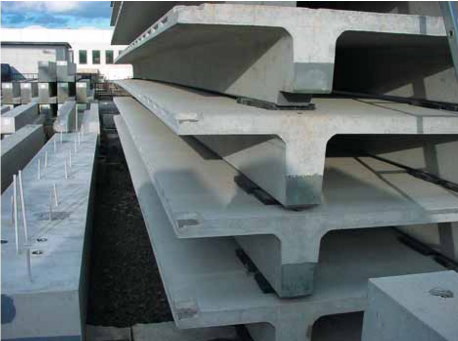
Foto 5.022: De kromming – zeeg - van de TT-plaat is duidelijk waarneembaar. In de hoek van de plaat is de inkassing met een staalplaatje waar te nemen, waarmee een gelaste doorverbinding van de TT-platen kan worden gerealiseerd
