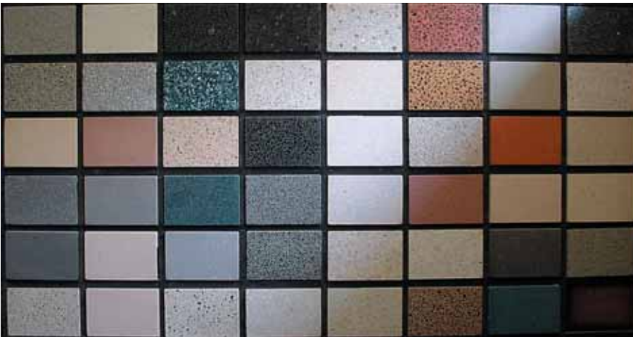
Foto 5.006: Een beeld van een monsteropstelling. Door de wijze van nabewerken, wassen, stralen en polijsten krijgt het beton een andere kleurnuance en een andere uitstraling
