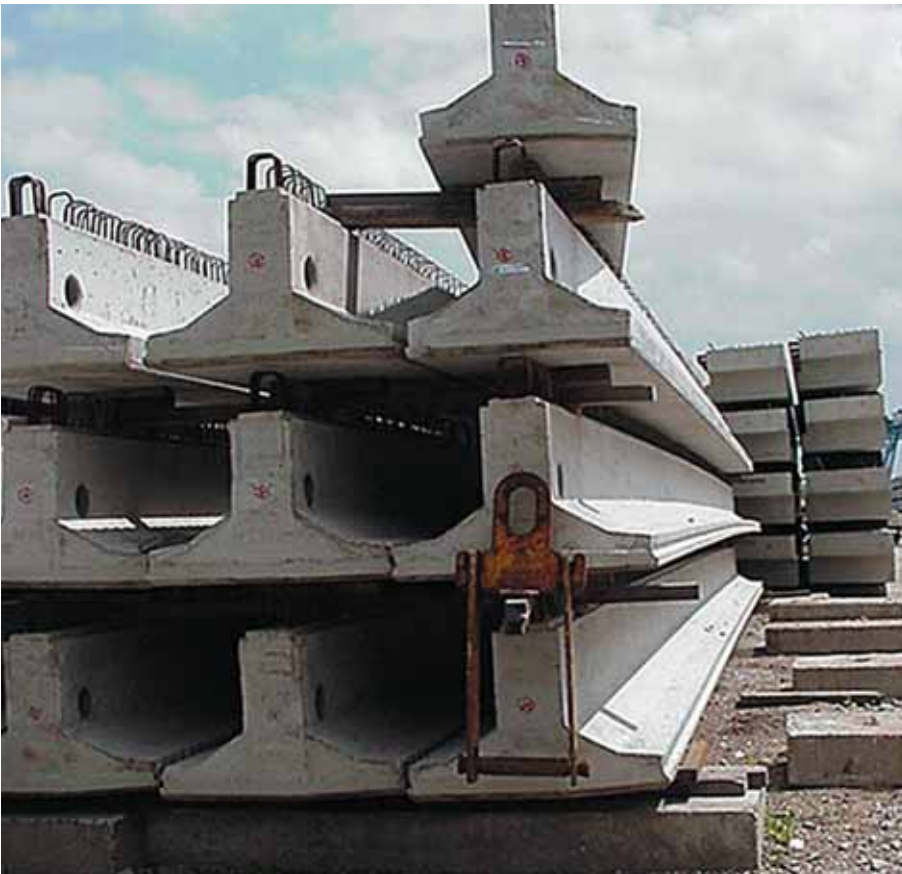
Foto 5.003: De zeeg van deze VIP-brugligger is duidelijk te zien als het oog de zijkant/onderkant van de ligger volgt
