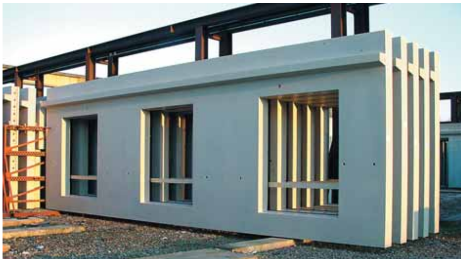
Foto 5.011: Basiselement, een dragend binnenspuwblad met kozijnsparingen, dat is voorzien van een oplegnok voor de oplegging van kanaalplaten
