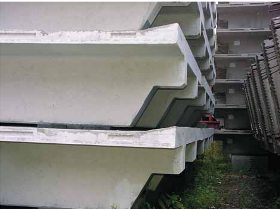
Foto 5.023: Een kleine opstand is aangebracht; de tand is voorzien van een schuine zijde
