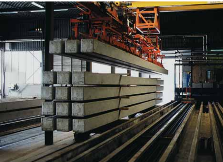
Foto 6.025: Via de techniek van het vacuümheffen worden de palen na eerste verharding en bewerking (doorslijpen spandraden) uit de mallen verwijderd om vervolgens circa 27 dagen uit te harden op het tasveld (in de buitenlucht dus) om de Normsterkte te bereiken
