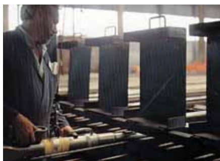
Foto 6.022 en 6.023: Het met behulp van vijzels op de juiste spanning brengen van de wapeningsdraden en het doorslijpen ervan na verharding van de betonspecie
