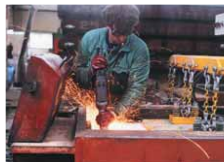
Foto 6.022 en 6.023: Het met behulp van vijzels op de juiste spanning brengen van de wapeningsdraden en het doorslijpen ervan na verharding van de betonspecie
