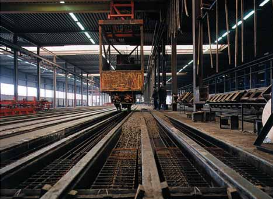
Foto 6.024: De aanvoer van specie bij het langebanksysteem. Duidelijk ziet men de voorspanstrengen, de kopwapening en zowel in als bezijden de mallen de schotten die de paallengte bepalen
