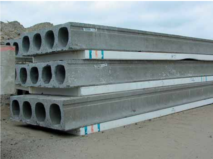
Foto 8.049: Geïsoleerde kanaalplaat op voorraad gelegd. Behoorlijke strengbezetting. Let ook op de bramen aan de onderzijde, omdat men de plaat niet tot op de baan zaagt, breekt deze restlaag wanneer de voorspanning gaat werken en de plaat wil gaan opbollen.
