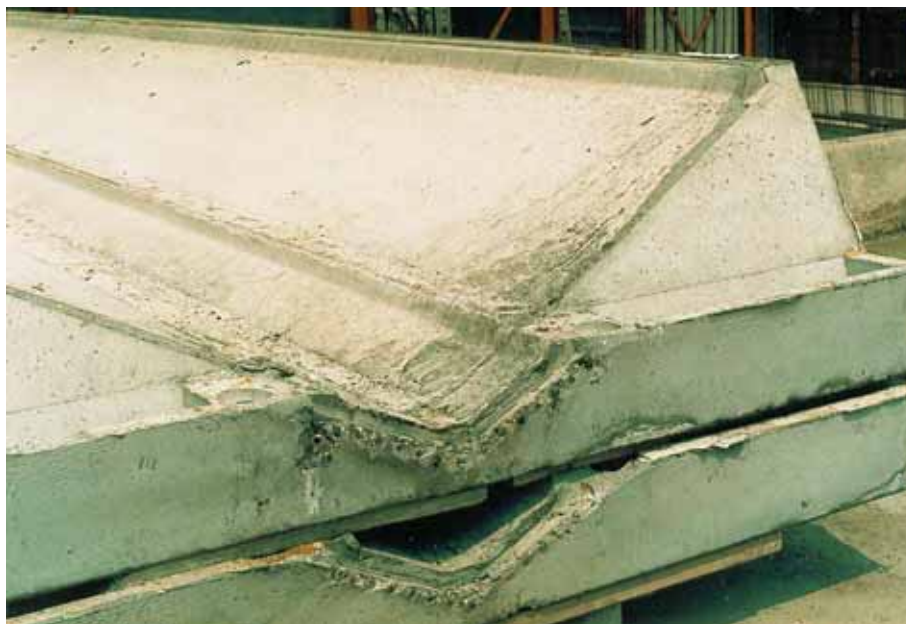
Foto 8.044: Shedelement in voorgespannen uitvoering, een product dat veel wordt toegepast in Italië. Goot zichtbaar aan de linkerkant. Het is een product met een gecompliceerde mal. De uitvoering lijkt ruig, het eindresultaat is fraai
