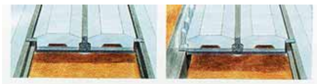
Raveelconstructie in het vloerveld Raveelconstructie bij de gevel
