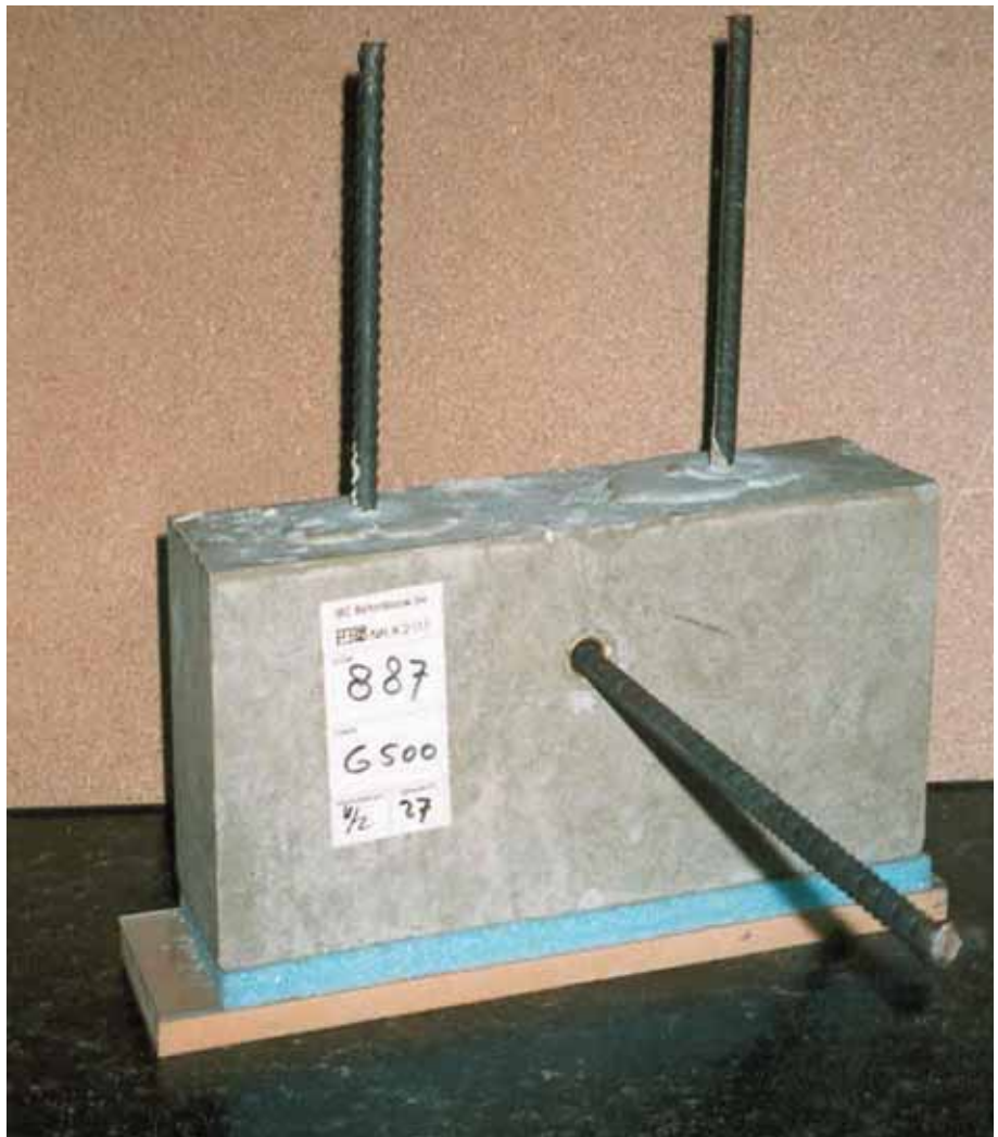
Foto 10.044: LEVO-blok, gedemonstreerd. Kunststofmal voor de omsluiting van de mortelvoeg onder het LEVO-blok, draadeinden voor verticale doorverbinding en als deuvels deelnemend aan de opname van horizontale krachten. Verder is een horizontale stek te zien, die in de voeg wordt ingestort en daarmee de samenhang in de constructie compleet maakt
