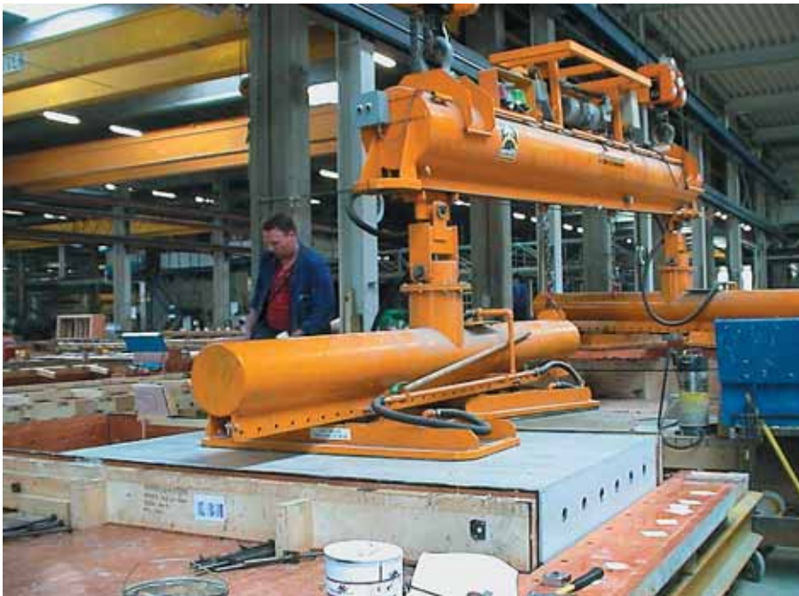
Foto 10.019: Horizontaal ontkisten met het vacuümapparaat, met twee zuignappen
