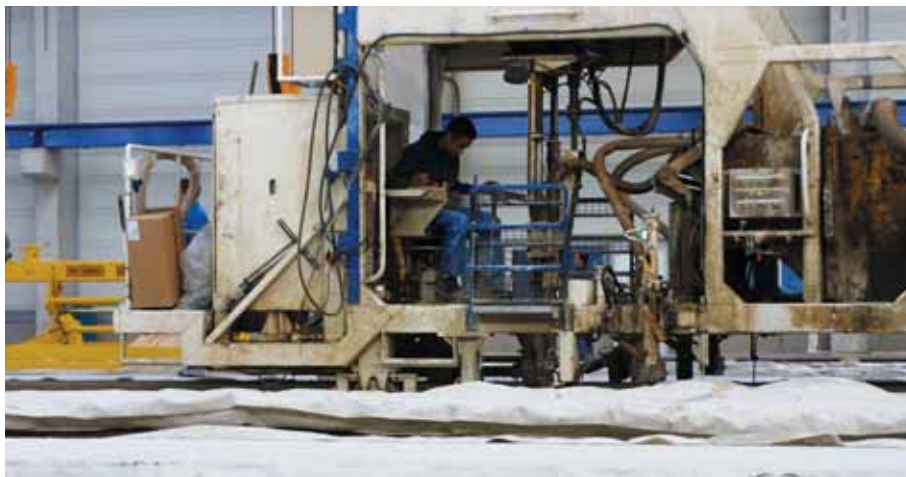
Foto 10.010: De productie van kanaalplaten is in stappen verdeeld. Er wordt hoogwaardige apparatuur ingezet, meestal CAD-CAM-gestuurd. Hier is de sparingzuiger ingezet om de sparingen te formeren en verse betonspecie op te zuigen en te verzamelen
