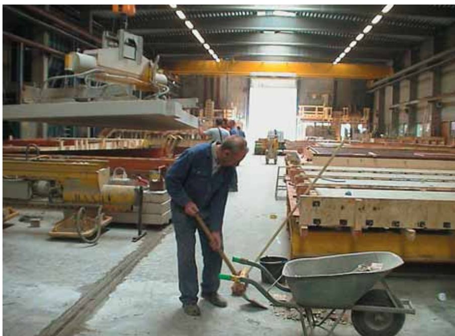
Foto 10.022: Op transport, zie verder de flexibele opstelling van tafels en mallen. Snel wijzigbaar, nodig voor de huidige vraag
