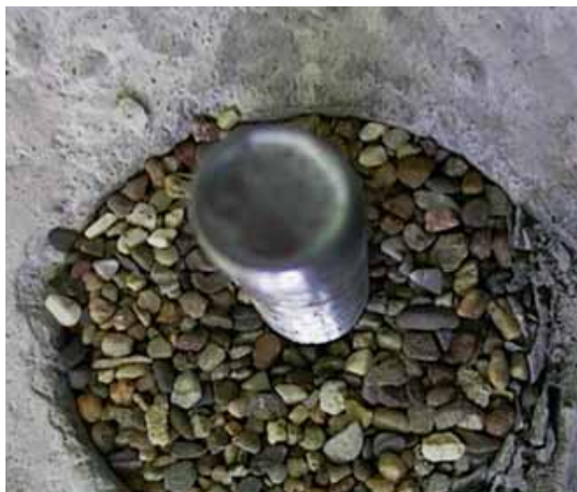
14 | Verplaatsing stalen dook bij vulling gat met grind
