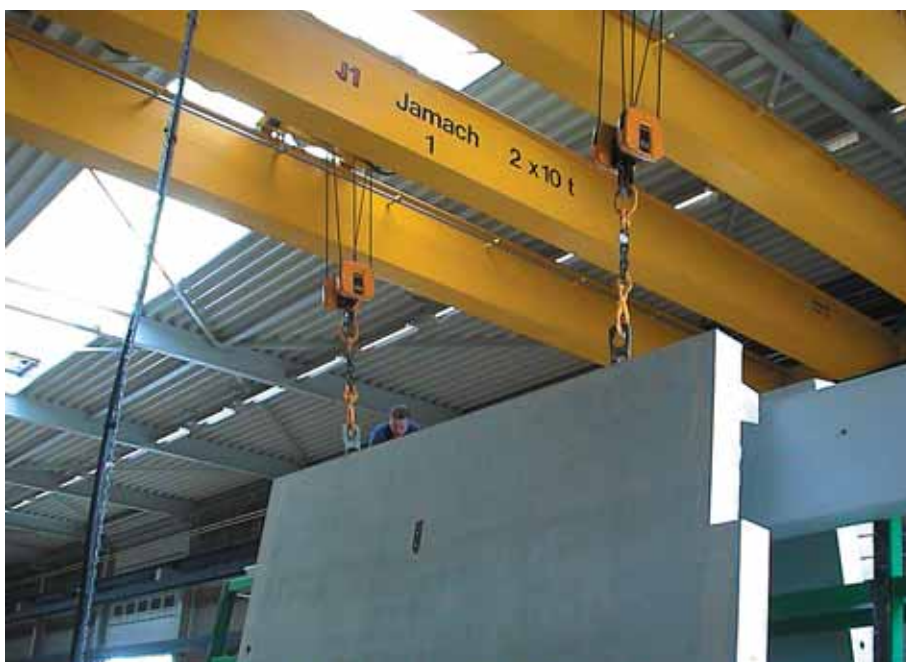
Foto 10.016: Het gaat op weg naar de tussenopslag in de hal, om zonodig te worden afgewerkt en enigszins af te koelen
