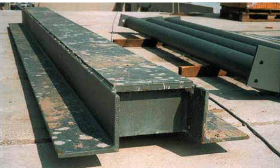
Foto 10.053: LEVO-balk, samengesteld uit handelsmaterialen
