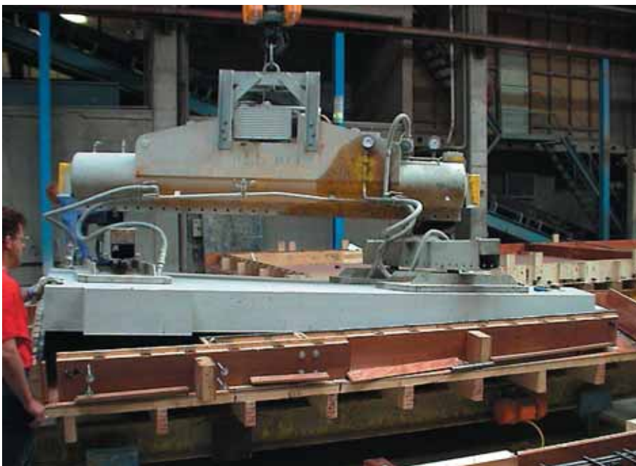
Foto 10.020: Het element is los. Dit is een klein element, het buigend moment ten gevolge van het eigen gewicht is gering
