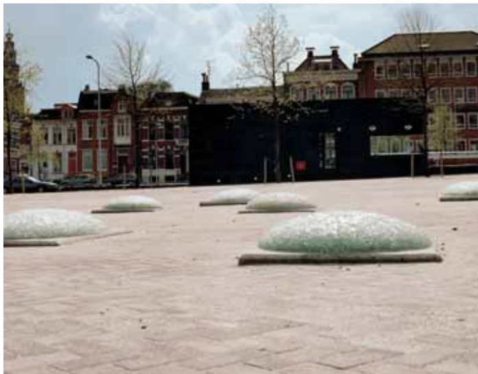
(boven) Ossenmarkt met massieve 'glasdruppels' en op de achtergrond de hoofd- in- en uitgang voor voetgangers (links) Onderzijde garage-dak met daarin opgenomen negen 'glasdruppels' annex daklichten (onder) De in de kade van Het Diep geïntegreerde hoofd- in- en uitgang voor voetgangers
