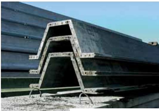
5-6 | Het vullen van de mal 7 | Het hijsen uit de mal 8 | Opslag van de spanwanden
