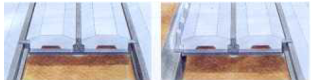
Raveelconstructie in het vloerveld
