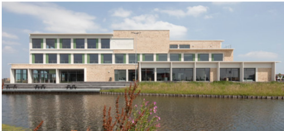
Geen grove borstweringen, maar een subtiel prefab sierbetonnen raster met grote glasopeningen zorgt samen met het metselwerk voor een Dudok-achtige sfeer.
